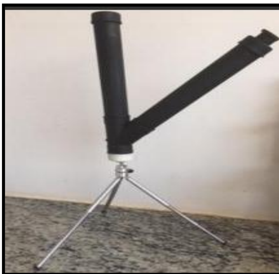
Figura 22– Espectroscópio feito com tubo de PVC e tripé. Fonte: Autor.
