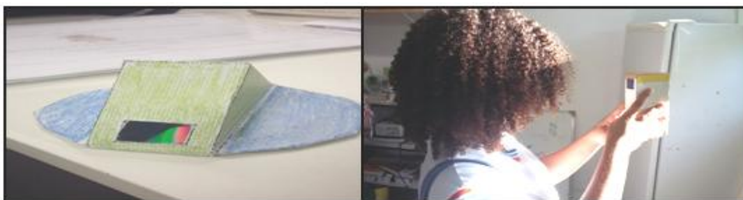
Figura 19 – Fotografia do modelo proposto de espectroscópio montado, exibindo espectros luminosos, e a direita, uma estudante utilizando um modelo adaptado por ela. Fonte: autor.
